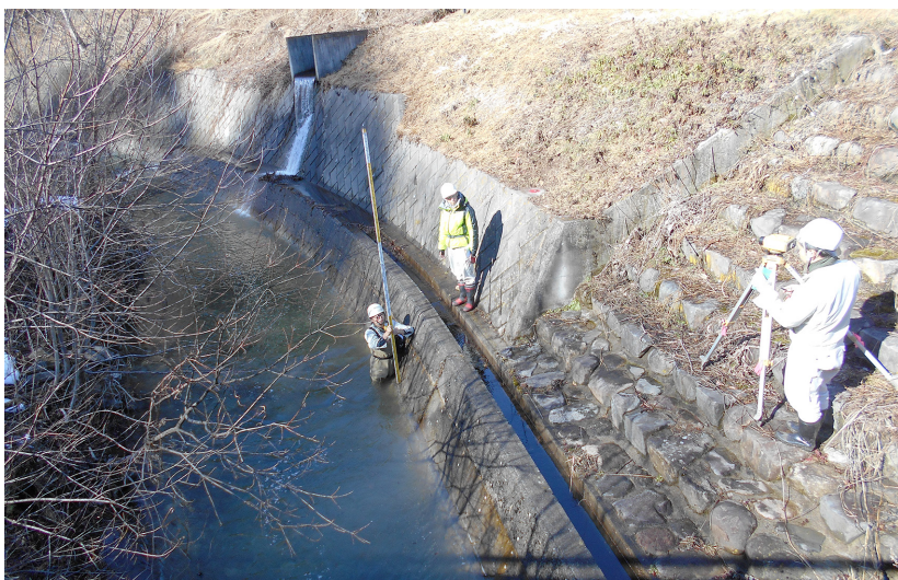
高度の基準点と水位の計測
